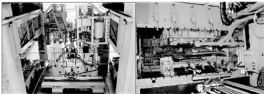
图7 机械手上下料配备穿梭机示例
