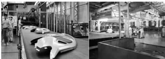
图 17 线尾出料系统示例
